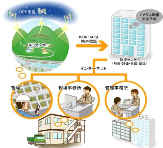
図-9 GPS計測監視センターの概念図
