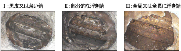
写真-5 PC鋼材腐食度 判定基準
