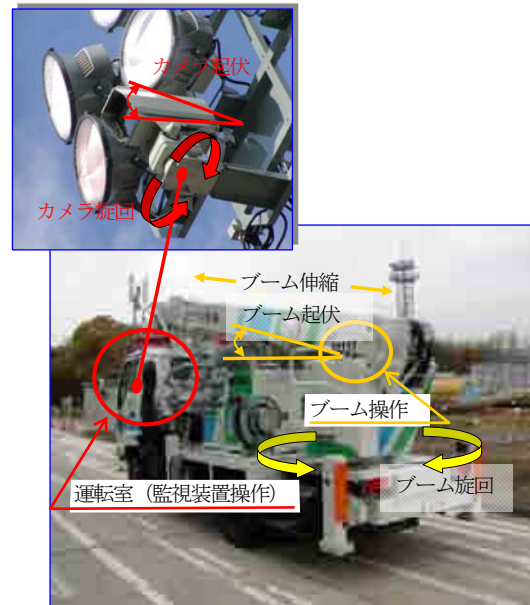
図-9 照明車のブーム操作と監視装置の操作 た高感度カラーカメラで映像情報を撮影し、照明車の運転室内へ送信する。カメラ操作は、IPエンコーダでデジタル化した映像を参照しつつ、運転室内やLAN接続したパソコンを用いて、運転室内外や対策本部車内などの遠方で行うことを提案する。
