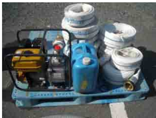
写真-7 エンジン付き仮設ポンプ
