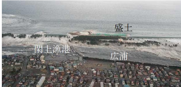
写真9 盛土による津波抑制性：名取市関上
