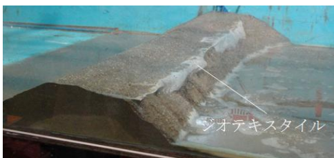
写真-12 部分補強(Dry)の越流後
