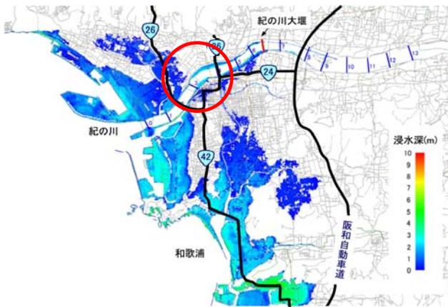
図-7.対策案（堤防嵩上げ）の解析結果浸水図
