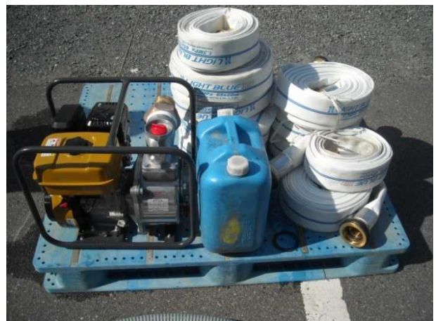
写真-7 エンジン付き仮設ポンプ
