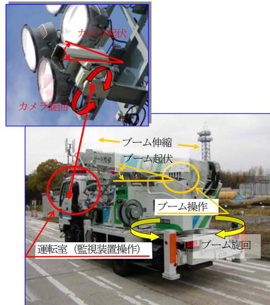
図-9 照明車のブーム操作と監視装置の操作
