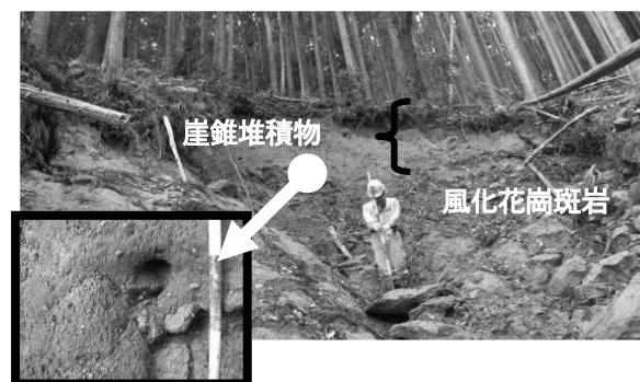
b) 表層崩壊とパイピングホール（平野川）
