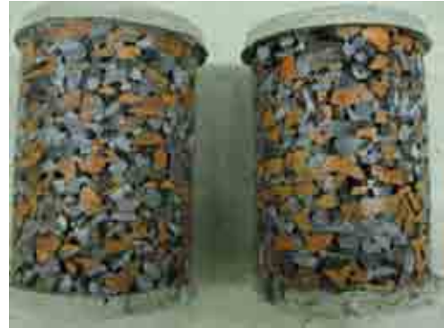
写真-13 凍結融解試験後 (No.⑦ 瓦50-C32(23))
