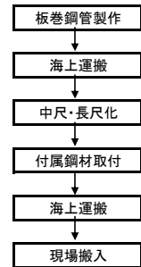
図-8. 鋼管製作フロー図
