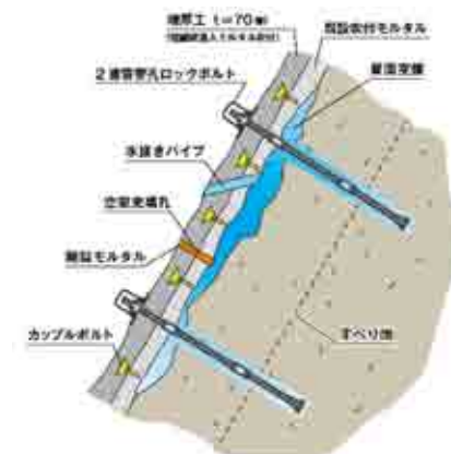
図3.7 工法概念図（タイプ5）
