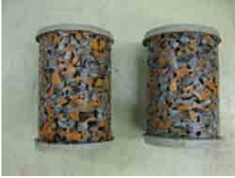
写真-8 凍結融解試験前 (No.⑤ 瓦50-C41(22))
