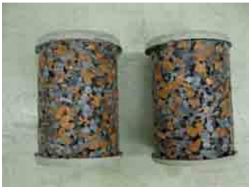
写真-10 凍結融解試験前(No.⑥ 瓦50-C41(20))
