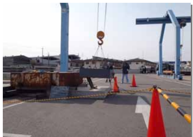
写真-7 重錘を鋼管支柱に衝突させた状況
