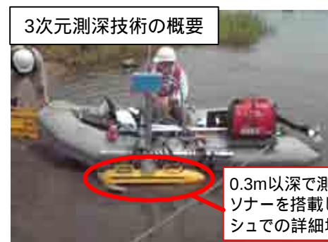
図-9 浅水域での3次元測深技術のイメージ
