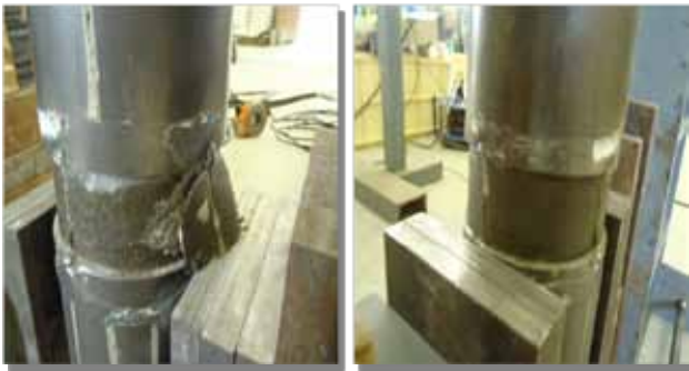
写真-5 補強支柱の破壊状況
