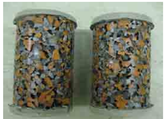
写真-7 凍結融解試験後（No.④ 瓦50-C38(20)）
