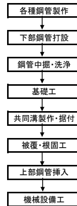
図-7. 施工フロー図
