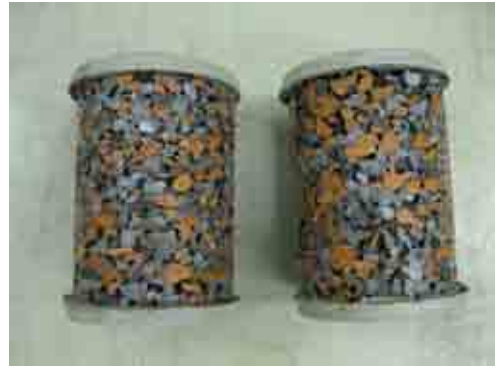
写真-12 凍結融解試験前 (No.⑦ 瓦50-C32(23))
