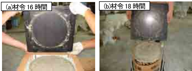
写真-6 剥離性試験結果
