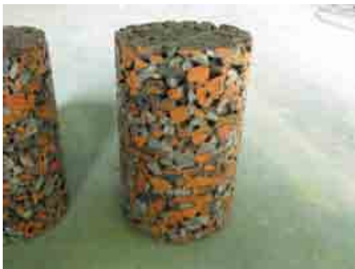
写真-3 円柱供試体作製状況
