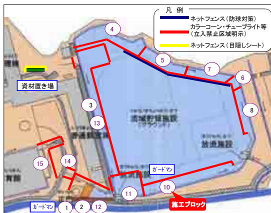
図-5 施工ブロック分割図(宝塚東高校)
