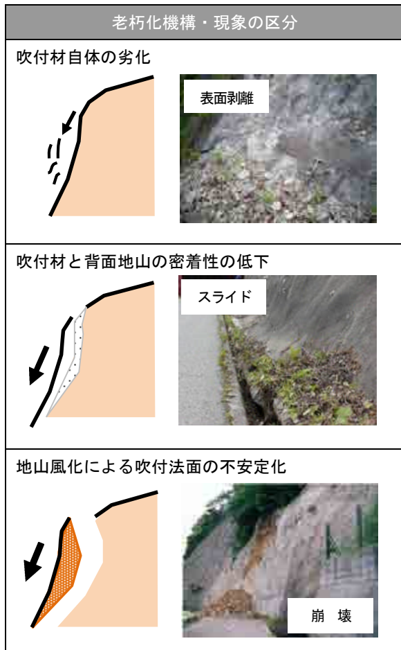
図-2 老朽化機構の区分
