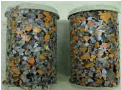
写真-11 凍結融解試験後 (No.⑥ 瓦50-C41(20))
