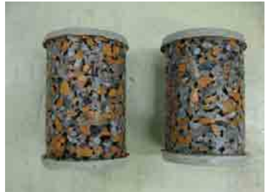
写真-6 凍結融解試験前（No.④ 瓦50-C38(20)）
