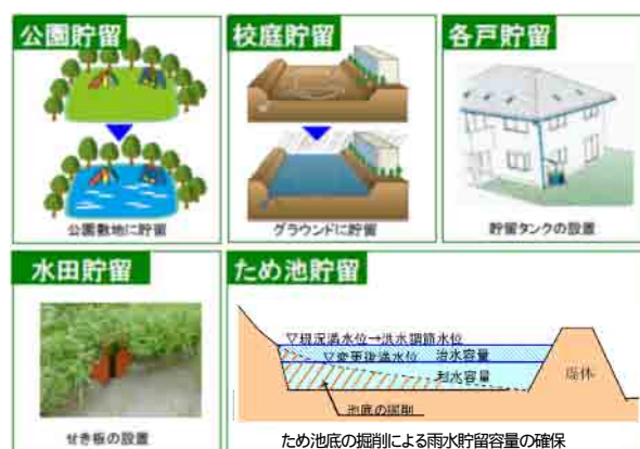
図-8 流出を抑制する流域対策の例
