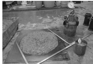
写真-3 スランプフロー試験
