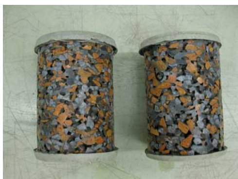
写真-10 凍結融解試験前(No.⑥ 瓦50-C41(20))
