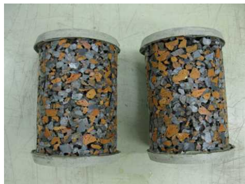
写真-12 凍結融解試験前 (No.⑦ 瓦50-C32(23))
