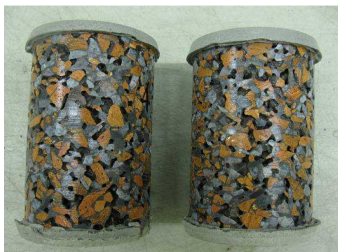
写真-9 凍結融解試験後 (No.⑤ 瓦50-C41(22))
