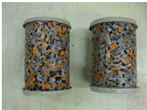
写真-8 凍結融解試験前 (No.⑤ 瓦50-C41(22))
