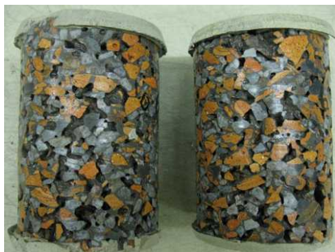
写真-11 凍結融解試験後 (No.⑥ 瓦50-C41(20))
