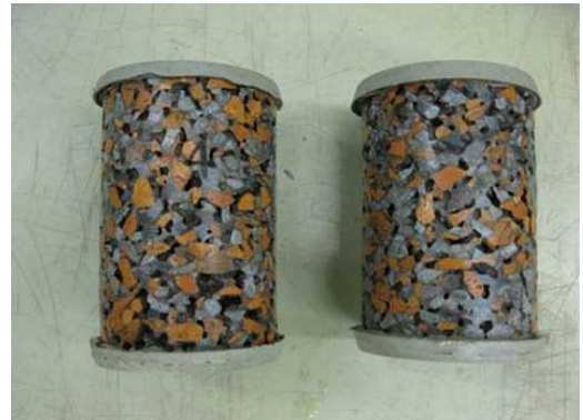
写真-6 凍結融解試験前（No.④ 瓦50-C38(20)）
