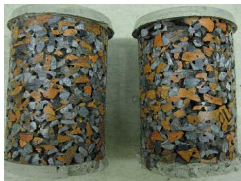
写真-13 凍結融解試験後 (No.⑦ 瓦50-C32(23))
