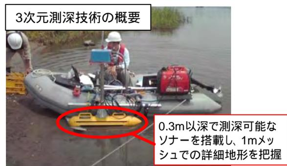
図-9 浅水域での3次元測深技術のイメージ
