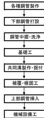
図-7. 施工フロー図
