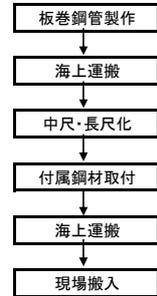
図-8. 鋼管製作フロー図
