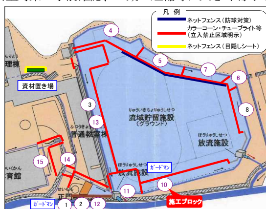
図-5 施工ブロック分割図(宝塚東高校)
