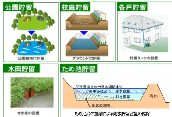
図-8 流出を抑制する流域対策の例
