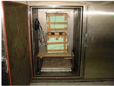
写真-1 温度調整装置
