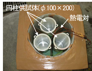
写真-4 型枠設置状況
