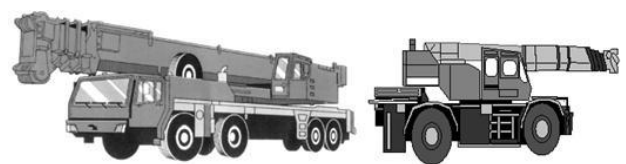
図2 特殊車両の例(自走式クレーン車)
