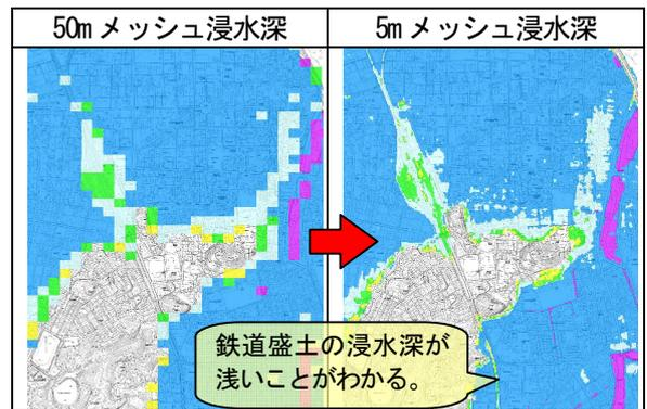
図-8 LPデータを活用した浸水状況の精度向上結果
