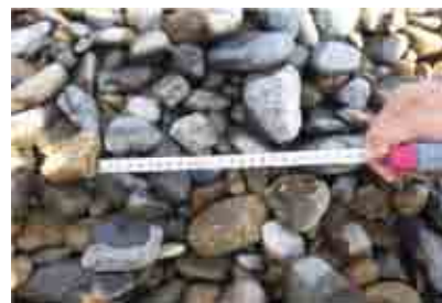
写真-9 ふるい分け後の土砂(改良後)
