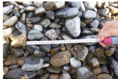
写真-9 ふるい分け後の土砂(改良後)
