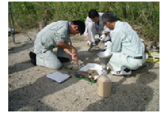
写真-7 砂置換法による土の密度試験
