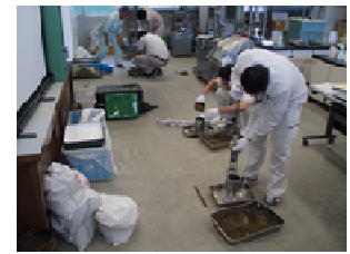
写真-5 締固め試験
