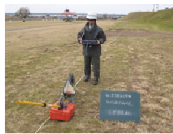
写真-3 地中レーダー探査状況
