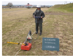
写真-3 地中レーダー探査状況
