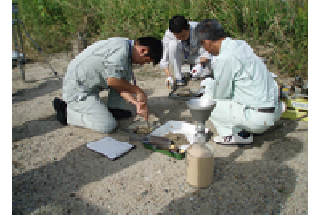
写真-7 砂置換法による土の密度試験
