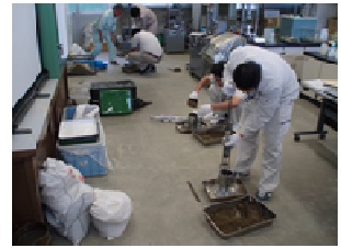
写真-5 締固め試験
