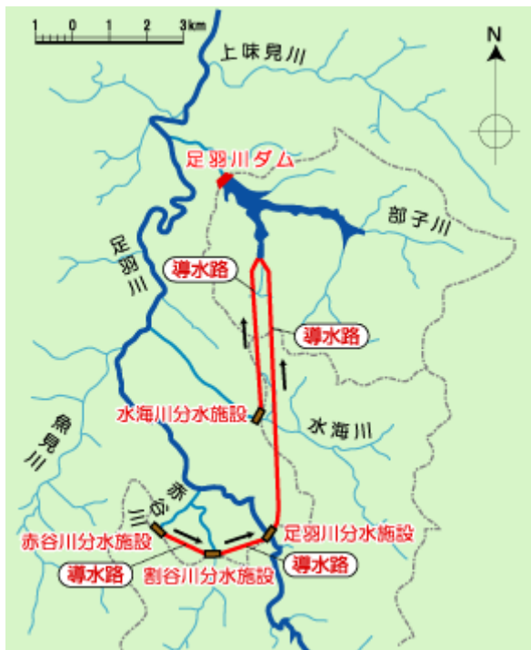
図-1 足羽川ダム計画平面図
