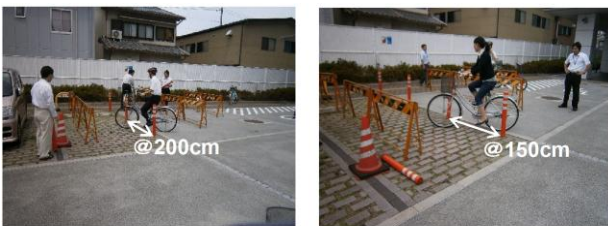
走行試験状況(ラバーポール@200cm) 走行試験状況(ラバーポール@150cm)
