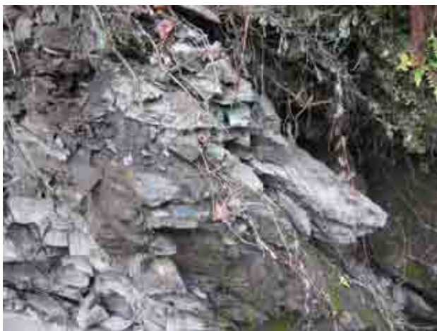
写真-2 危険斜面における脆弱な基盤岩
