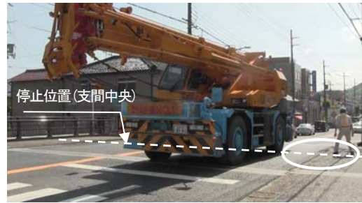
写真-2 静的載荷試験状況
