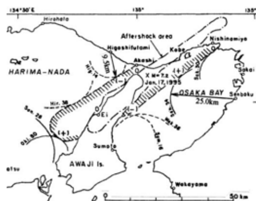
図-5 波源域の推定図 6,7,18) (波速の推定測線を記入, 部分を編集)
