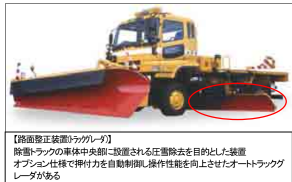
写真4-1 除雪トラック（路面整正装置）
