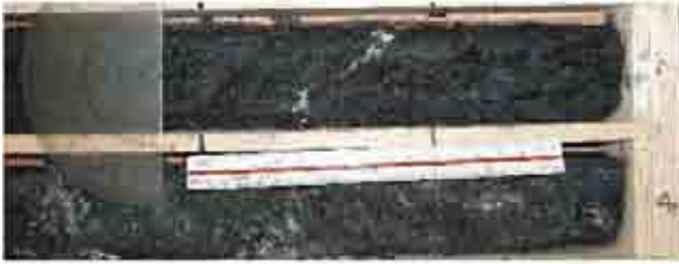
写真3.4 20度～80度の亀裂多く、粘土化が進む。
