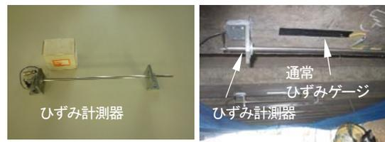
写真-3 計測器の設置状況
