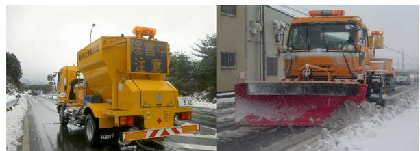
写真2-1 除雪状況(左:凍結防止, 右:新雪除雪)
