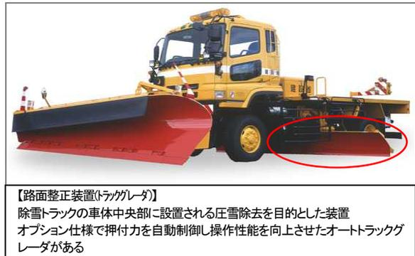
写真4-1 除雪トラック(路面整正装置)
