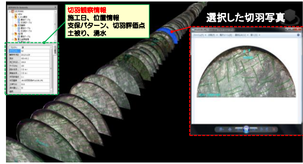
図-6 施工情報の取込み（切羽観察）
