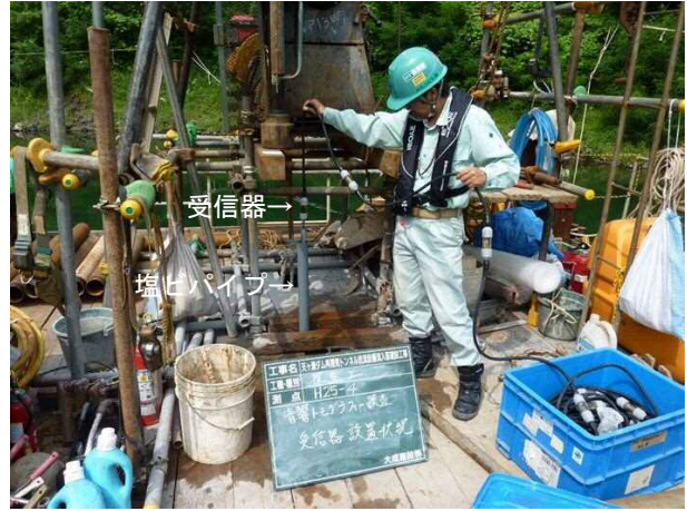
写真-5 調査状況 (受信孔)
