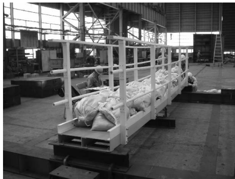
図-4 試験状況（活荷重全載）
