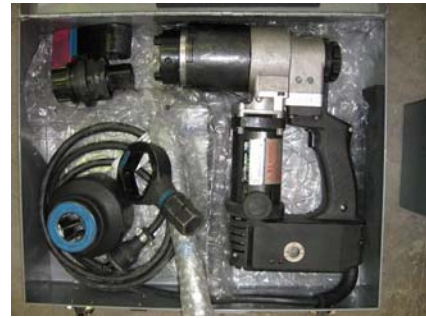
図-8 Rアンカー抜き取り機器
