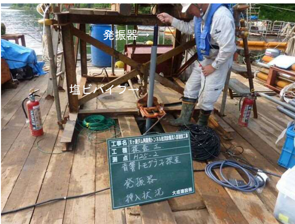
写真-3 調査状況 (発振孔)
