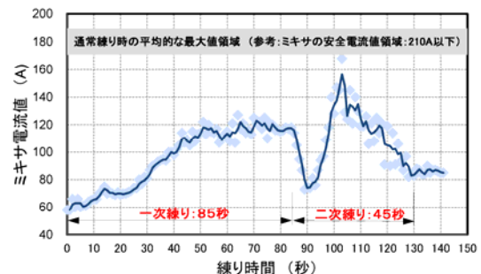
図-5 練り混ぜ中のミキサ負荷
