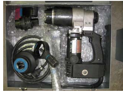
図-8 Rアンカー抜き取り機器
