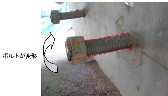
図-5 コーティングがない場合の抜き取り状況(試験体)
