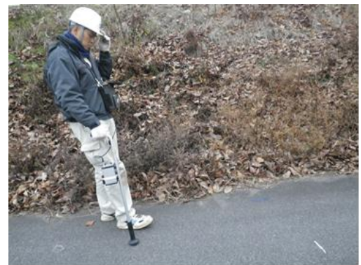
写真-5 ガス検知状況①
