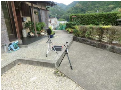
図-6 N宅における低周波音レベル測定状況
