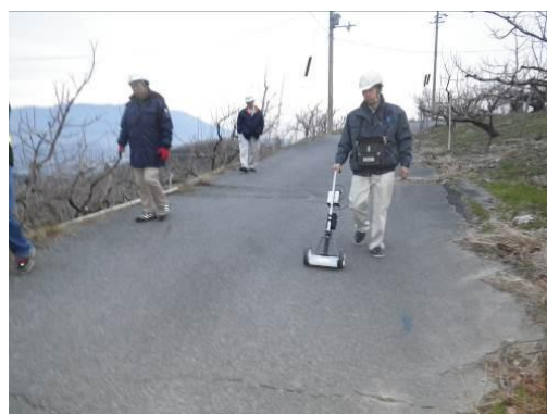
写真-6 ガス検知状況②
