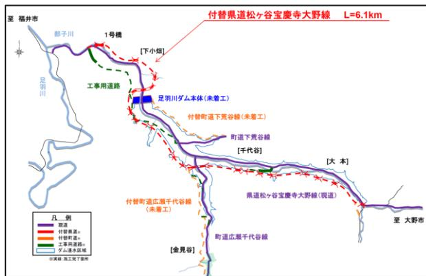
図-3 足羽川ダム建設事業施工箇所(2014年度)
