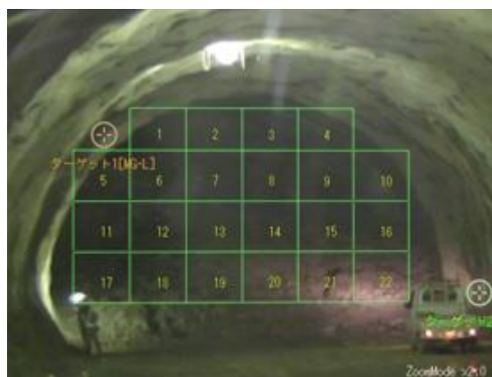
図-3 AR（拡張現実）技術を用いた切羽断面写真
