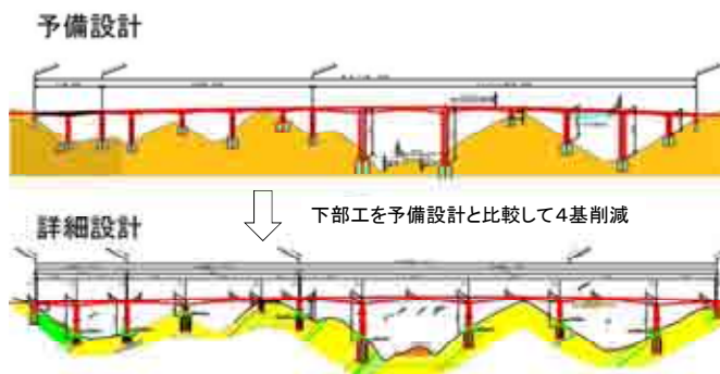
図-4 支間割りの見直し（雄ノ山高架橋の例）
