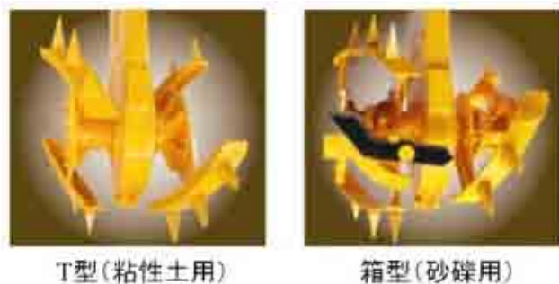
図-7 WILL工法で用いる攪拌翼形状
