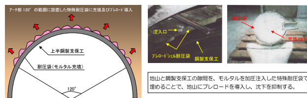
図-10 プレロードシェル工法説明図
