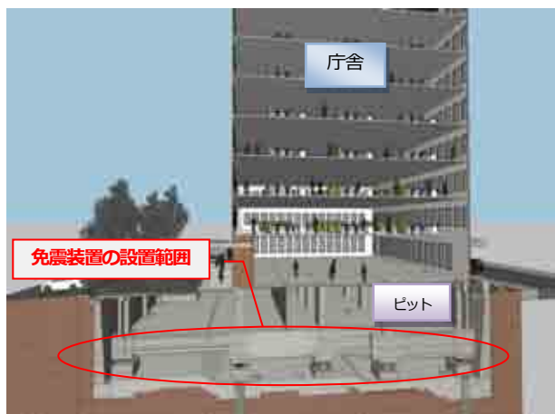
図 2-3：免震装置の設置範囲
