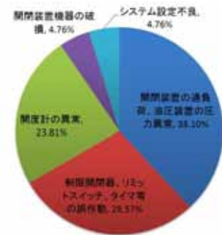
図-4 操作不能となった不具合の事象別グラフ
