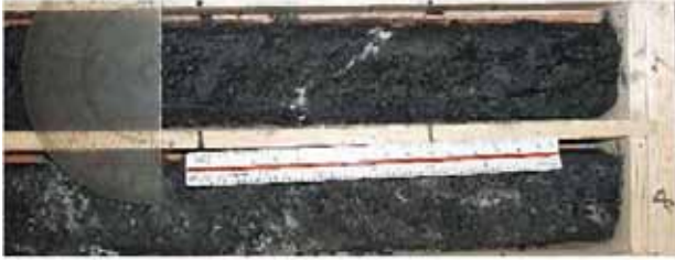
写真3.4 20度～80度の亀裂多く、粘土化が進む。
