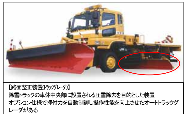
写真4-1 除雪トラック（路面整正装置）
