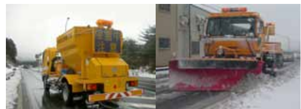
写真2-1 除雪状況(左:凍結防止, 右:新雪除雪)
