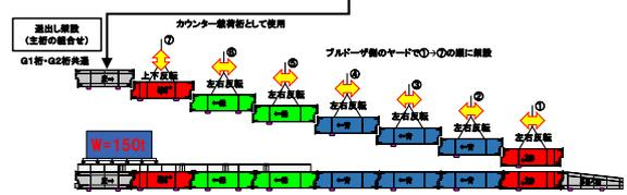
図-12 60m 級緊急仮設橋 主桁ブロック組合せ図
