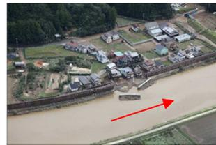
写真-4 高岡輪中堤の転倒
