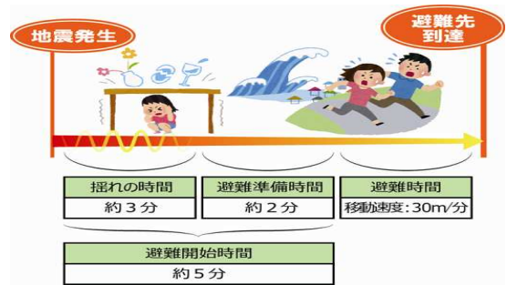
図-2 避難開始時間と移動速度の考え方
