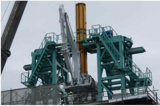
図-8 水中作業機昇降状況
