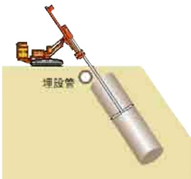
図-2 地中埋設物をかわした施工状況
