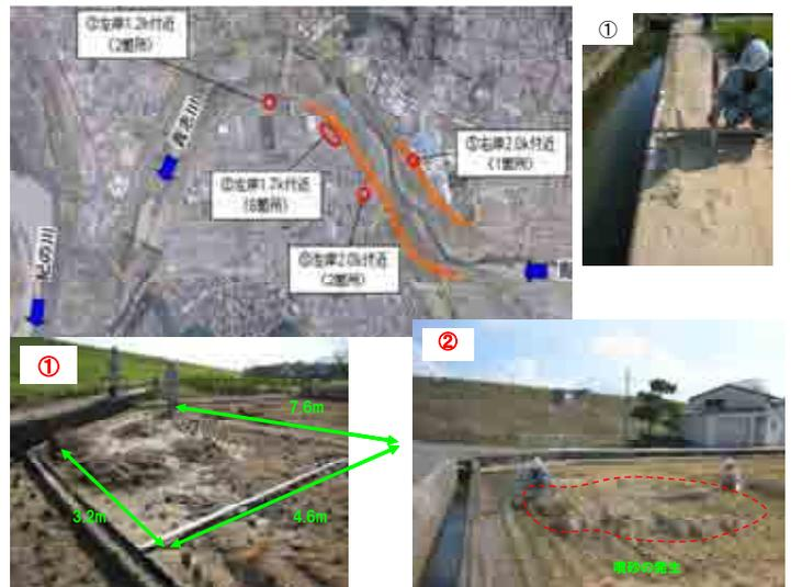
図2 2011年(平成23年)9月台風12号時の噴砂状況
