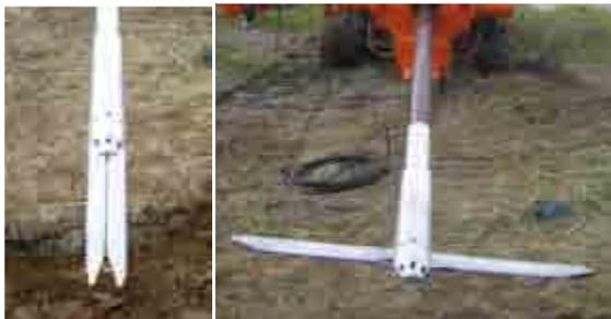
写真-1 攪拌翼開閉状況
