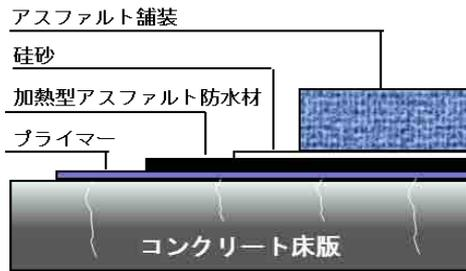
図-2 塗膜系床版防水層（アスファルト加熱型）の構成
