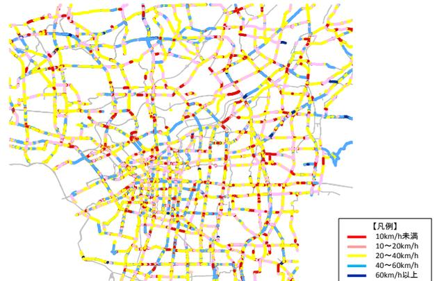
図-9 一般道路の速度（8時台平均；工事前）
