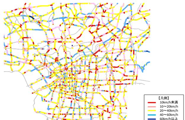
図-10 一般道路の速度（8時台平均；工事中）
