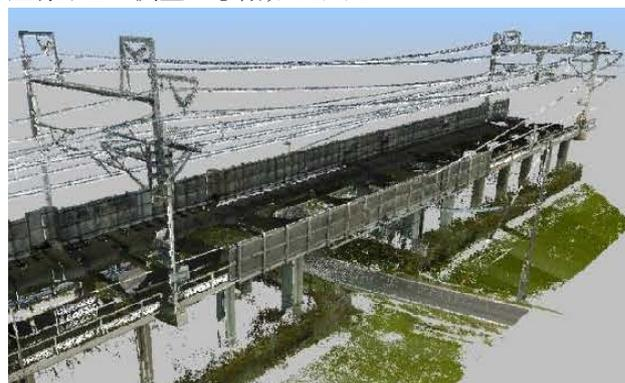
図-18 鉄道高架の点群データ
