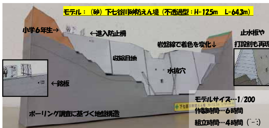
写真-1 携帯型砂防えん堤
