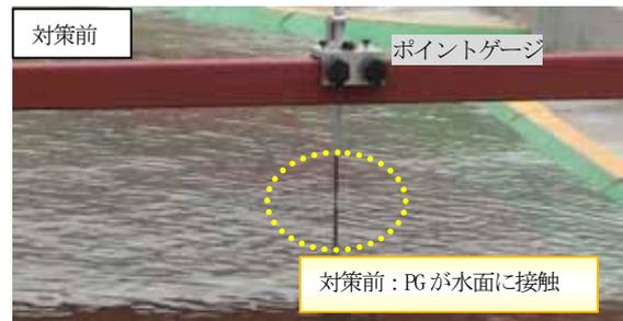
写真-4 対策前の水位 (模型実験)
