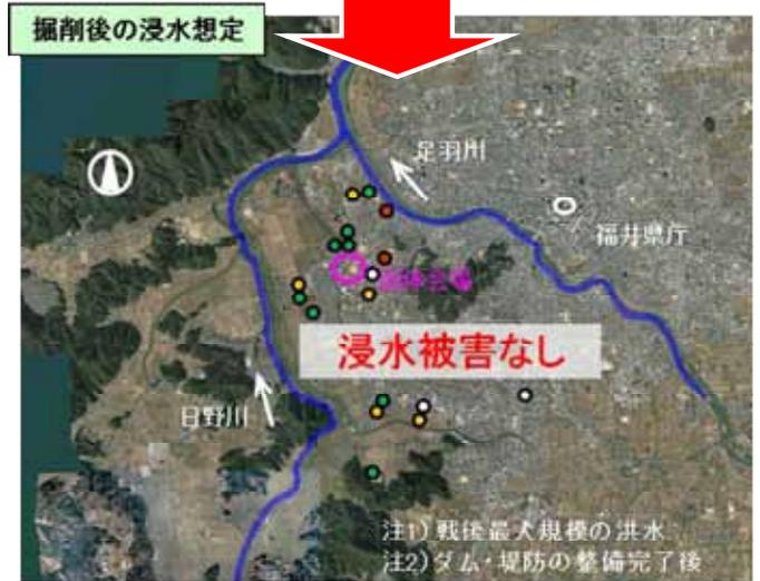
図-5 日野川の河道掘削効果
