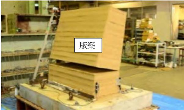
写真5-3-2-1 (A) 試験体の浮き上がり破壊形式
