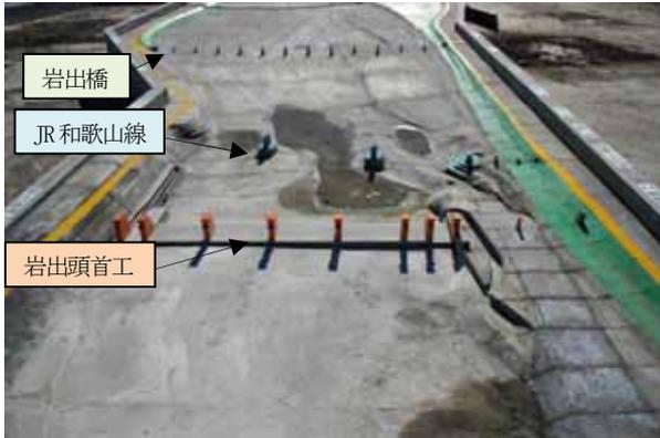
写真-3 縮尺 1/100 で再現した実験模型
