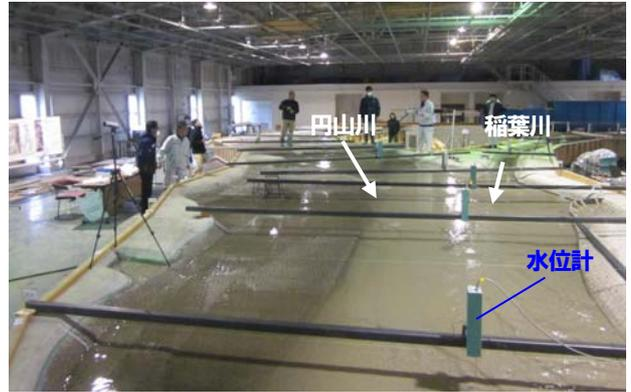
図-7 河道水理模型の現地写真
