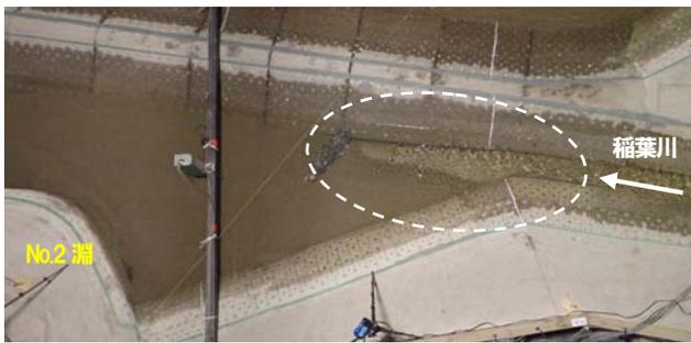
図-17 稲葉川急拡部の洗掘状況
