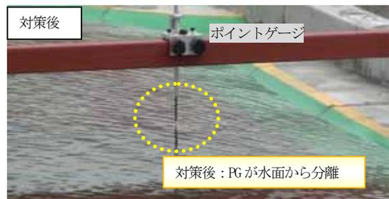
写真-5 対策後の水位 (模型実験)
