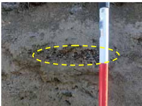
写真-15 S-4 : 反応を検出した位置で分布していた礫
