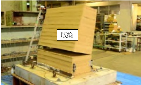
写真5-3-2-1 (A) 試験体の浮き上がり破壊形式
