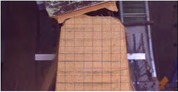
写真5-3-2-2 (D) 試験体頂部破壊状況
