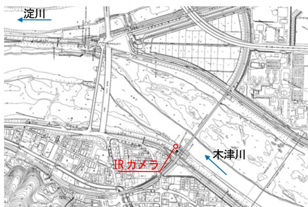
図-5 八幡地点における遠赤外線カメラ設置位置
