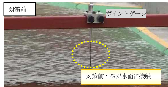
写真-4 対策前の水位（模型実験）
