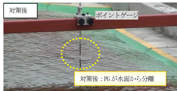
写真-5 対策後の水位（模型実験）
