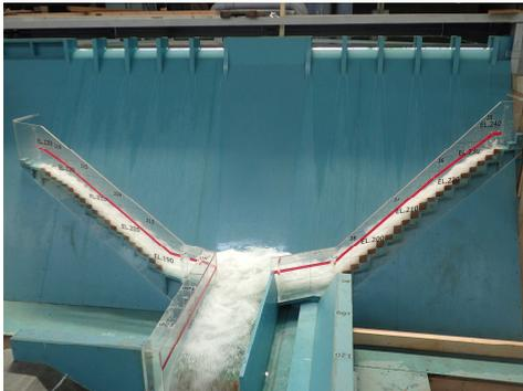
図-15 足羽川ダム水理模型実験状況
