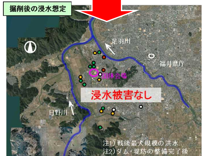
図-5 日野川の河道掘削効果
