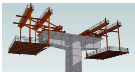
図-3 ワーゲンによる張出架設
