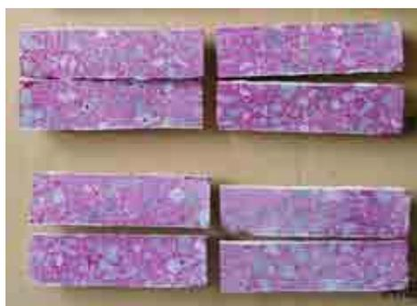
写真-5 中性化深さ試験状況
