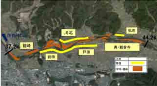
図-3. 河道掘削及び築堤位置
