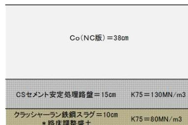
図-7 エプロン舗装断面図
