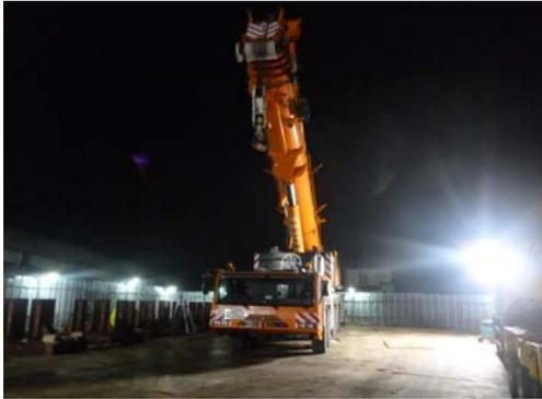
図-14 360 t吊りラフテレーンクレーン
