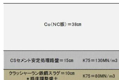
図-7 エプロン舗装断面図
